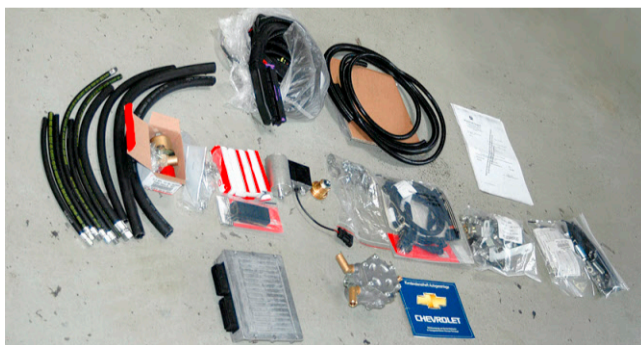
Das gehört zu einem LPG-Nachrüst-Kit: Gasleitungen, Einblasdüsen, Verdampfer, Steuergerät, Kabelbaum, ECE R115-Zertifikat, Einbauanleitung, Filter, Tankadapter, Kleinmaterial.
