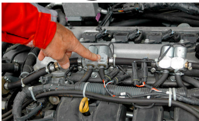
Die Lebensdauer eines Motors bei einer LPG-Nachrüstung hängt stark von der Einblasmenge Flüssiggas ab. Da braucht's Fachwissen.
