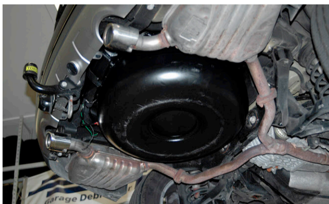
Beim Chevrolet Captiva kann der Flüssiggastank unterflur montiert werden und nimmt so im Kofferraum keinen Platz weg.
