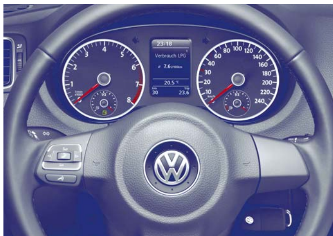
Tankanzeige für Autogas und Benzin sowie die neue Verbrauchsanzeige auch für Autogas im Kombiinstrument sind perfekt integriert. Das ist OEM-Standard.
